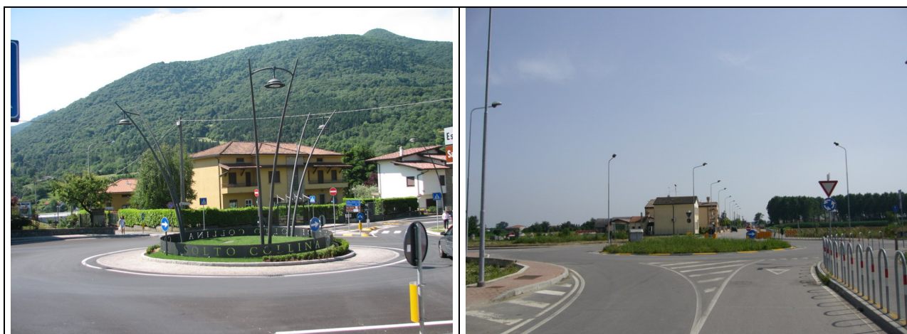
Figura 2.9 - Impianti di rotonde conformi alla L.p. 16/07 con apparecchi stradali posti centralmente o esternamente.
