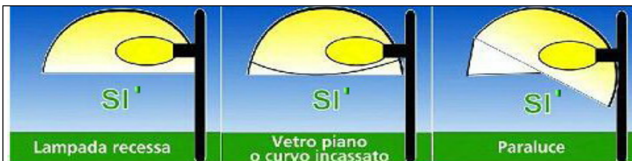
Figura 2.2 – Tipologie di apparecchi conformi alla L.p. 16/07 (cortesia: CieloBuio)
