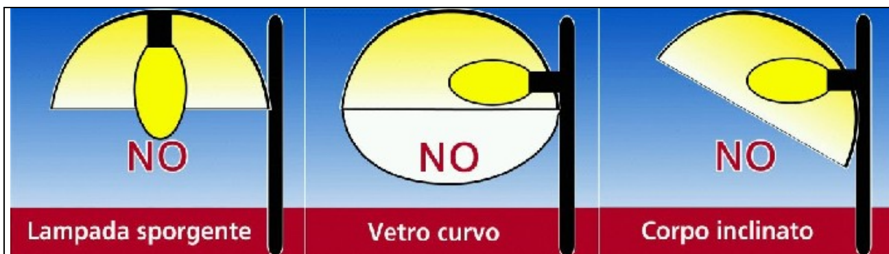
Figura 2.1 – Tipologie di apparecchi non ammessi (cortesia: CieloBuio)
