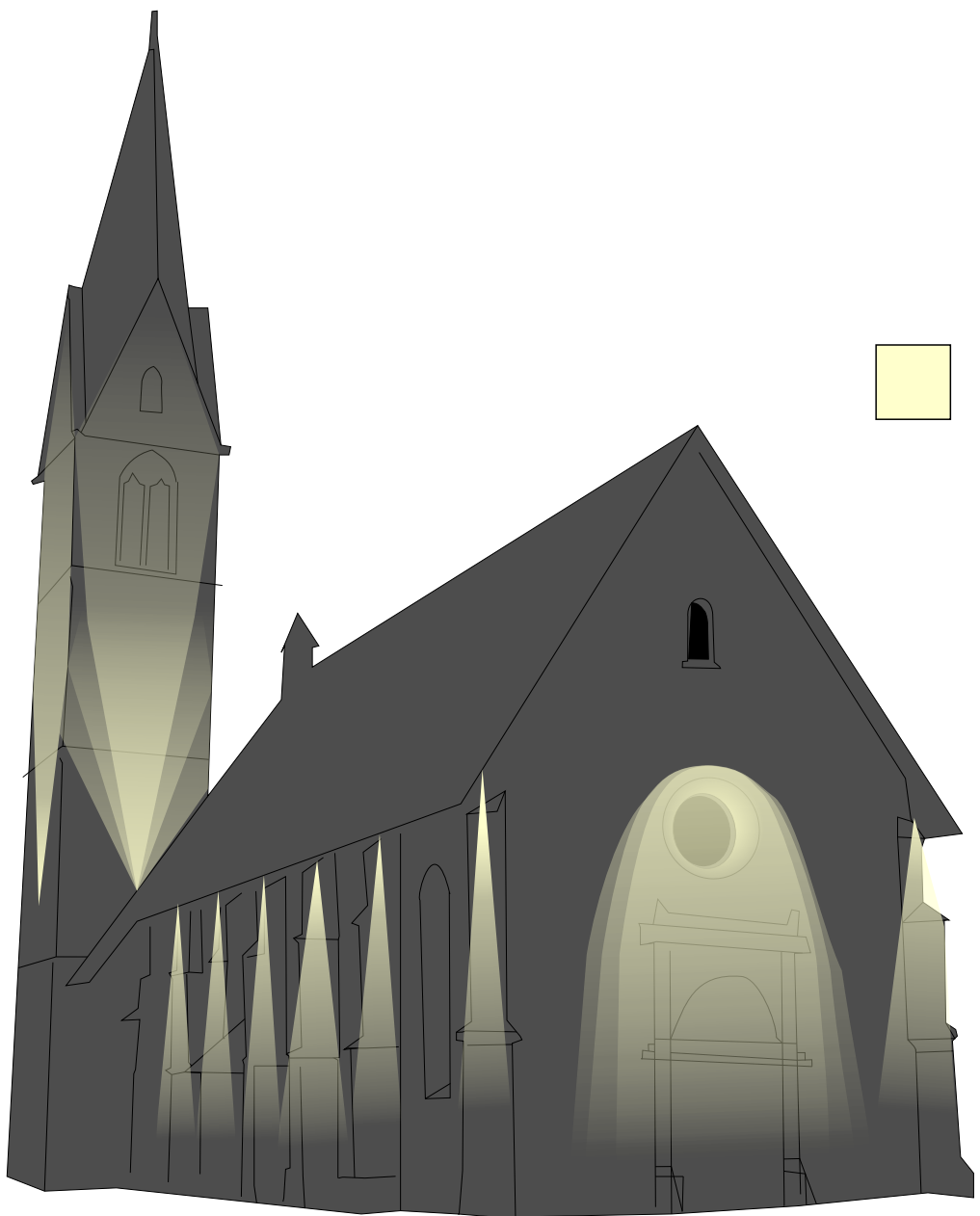
Esemplificazione dei fasci luminosi illuminanti l'architettura della chiesa in modo puntuale
